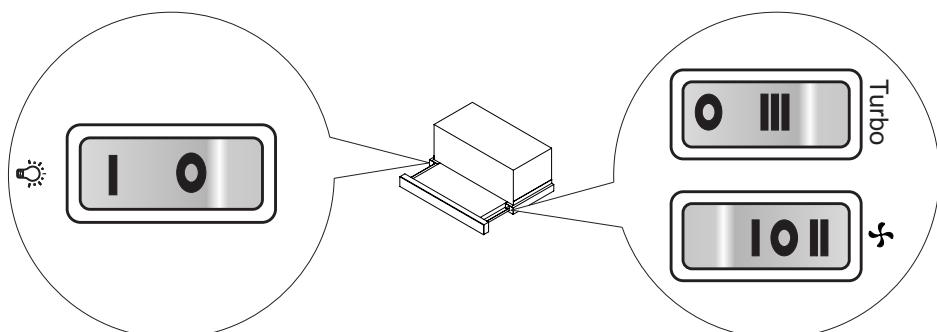
Panel sterowania wyposażony jest przyciski (kołyska). Są one widoczne po wysunięciu frontu teleskopowego.
