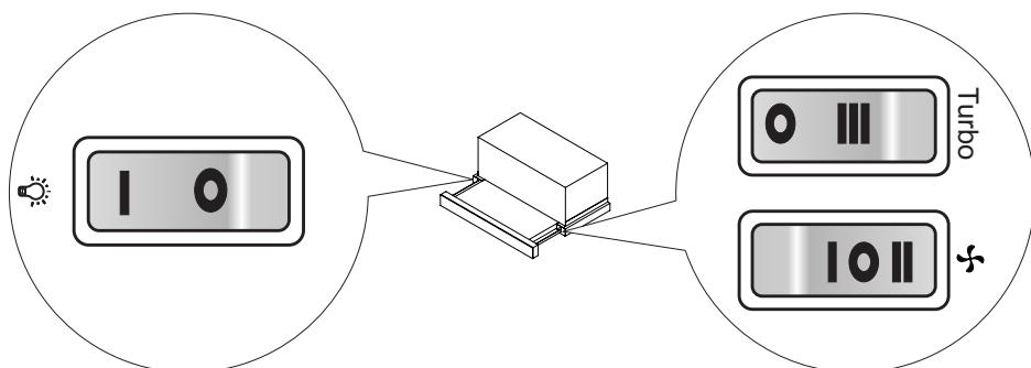
Upravljalni panel je opremljen z gumbi (mehanski). Vidni so, ko izvlečemo sprednji teleskopski del.
