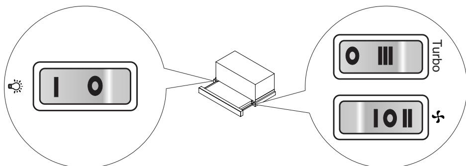
Панелът за управление е оборудван с бутони от тип rocker. Те се виждат след изтегляне на телескопичния фронт на абсорбатора. Телескопичният абсорбатор е оборудван с краен прекъсвач. Всеки път, когато изтегляте телескопичния фронт, абсорбаторът ще започне работа с последната зададена скорост.
