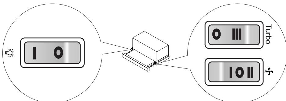
Ovládací panel je vybaven tlačítky (kolébka). Tlačítka jsou viditelná po vyklopení čelního panelu.
