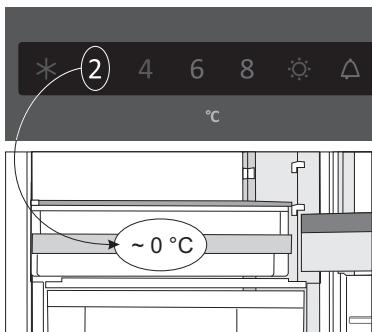
Při teplotě okolo 0 °C v přihrádce **ZeroZone** doporučujeme nastavit teplotu lednice na hodnotu nižší než 4 °C.
