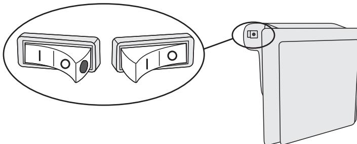
Když je ionizátor zapnutý, objeví se na spínači červená tečka.
