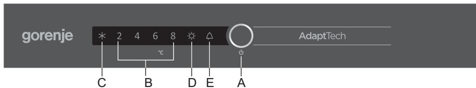
**A Vyp/Zap zařízení, nastavení teploty, spínač pro extra funkce**
