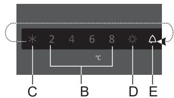
V případě vysoké teploty ve spotřebiči se aktivuje zvukový alarm (přerušovaný tón) a symbol **E** se rozsvítí.
