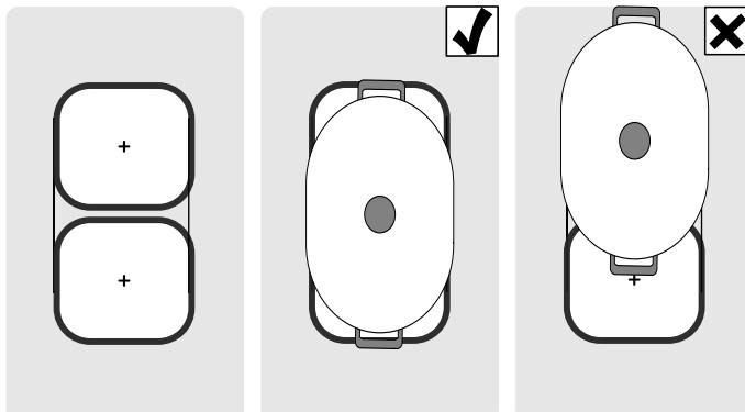
Když používáte jen na jedné ze dvou vyrných zón jen jednu nádobu, můžete ji přesunout na druhou varnou zónu. V tom případě bude převzatý stupeň ohřevu a zvolená nastavení.
