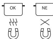
Používejte pouze hrnce a pánve vyrobené z feromagnetického materiálu, které jsou vhodné pro používání na indukčních varných deskách. Abyste určili, zda je hrnec vhodný, hledejte symbol (obvykle vyražený na dně). Magnet lze použít ke kontrole, zda hrnce jsou magnetické.
